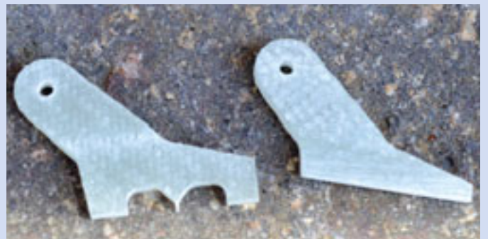
Beschliffen! Die GfK-Ruderhörner müssen deutlich gekürzt werden.
