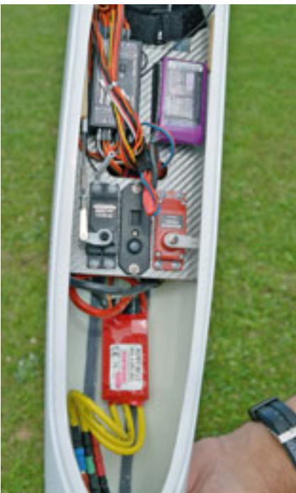
Der Stützakku bringt zusätzliche Sicherheit, verschaltet über einen Powerbox-Sensor.
