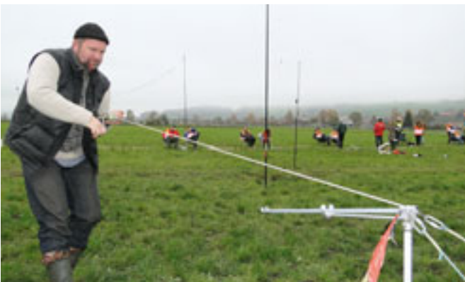
Aufziehen des Gummimotors, der ca. 380 Umdrehungen ermöglicht.
