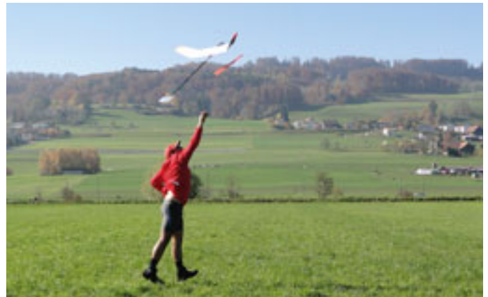
Schnur-Hochstart eines Freiflug-Segelmodells (F1A).
