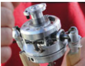
Innenleben des Propellerkopfs eines Gummimotormodells.
