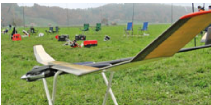
Der elektronische Zeitschalter löst die Steig- und Steuerfunktion sowie die Thermikbremse aus.
