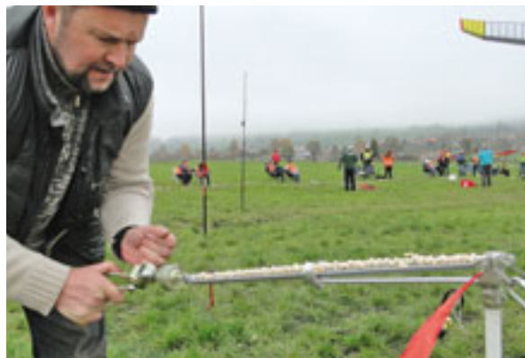
Aufziehen des Gummimotors, der ca. 380 Umdrehungen ermöglicht.
