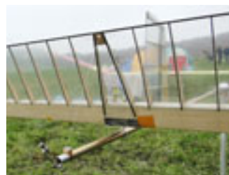
Höhensteuer als Thermikbremse.
