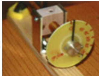
Der Drehmomentmesser für das genaue Aufdrehen des Antriebsgummis.
