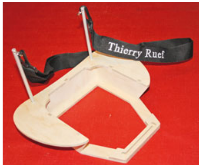
Pupitre assemblé collé à la colle blanche et sangle personnalisée.
