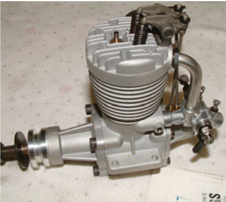
Ein solcher Motor wurde von Maynard Hill so optimiert, dass er mit rund 2 l Treibstoff fast vierzig Stunden laufen sollte.
