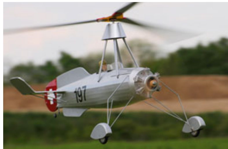
Le C30 de RC Star Model est un autogyre avec un rotor de 1800 mm.
