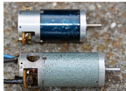
Motor Keller 80 und 100, vielfach in Grosseglern eingesetzt.
