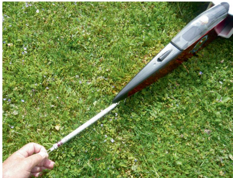
Bild 5: Messung der Bodenreibung mittels Federwaage.
