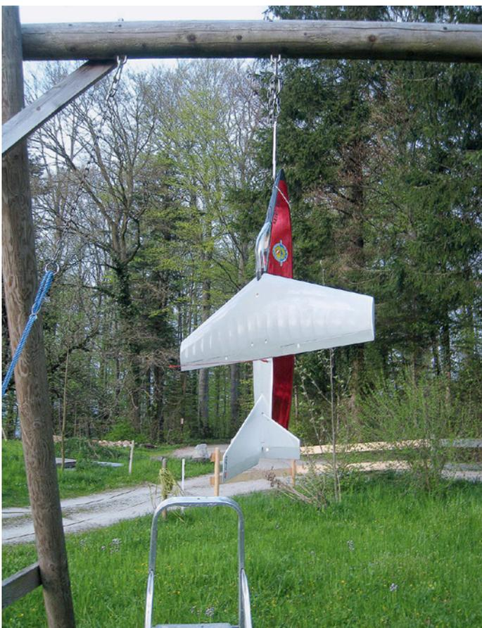
Bild 4: Messung von Masse (1,2 kg) und Standschub (4,5 N).
