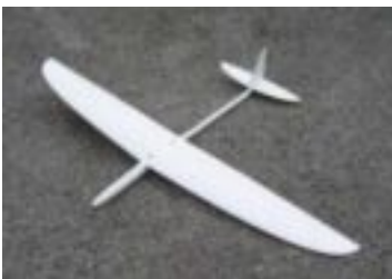
Energy Voll GFK Spannweite 1.5 m
