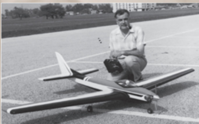
Kaz mit seinem um 150% vergrößerten und verbesserten Taurus: der Simla. Viele ihrer Neuerungen waren damals unbekannt, wie zum Beispiel steckbare Flügel und einstellbare Stabilisatoren. Dieser Teil der Geschichte ist noch nicht zu Ende.
