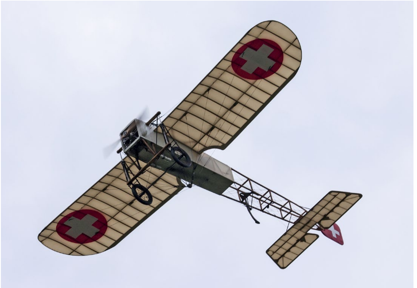
Jede einzelne Rippe der aus Holz gebauten Tragfläche ist deutlich erkennbar. Chaque nervure individuelle de la surface portante (construite en bois) est nettement reconnaissable.
