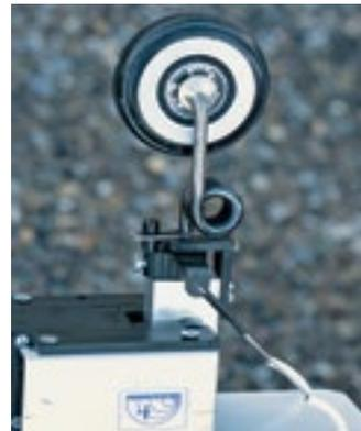
**Bugfahrwerk auf Alu-Konsole ermöglicht die Zuführung zum Resonanzrohr.**
