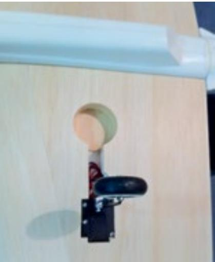
**Fahrwerk und Rumpf-Unterteil als Resorohr-Abdeckung.**
