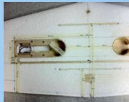
**Styroporflügel mit Verstärkung und Fahrwerkschächten.**
